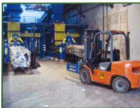
5. Prensado material recuperado
